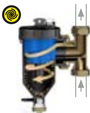
Krok 1. Wprowadzenie czynnika w ruch wirowy
